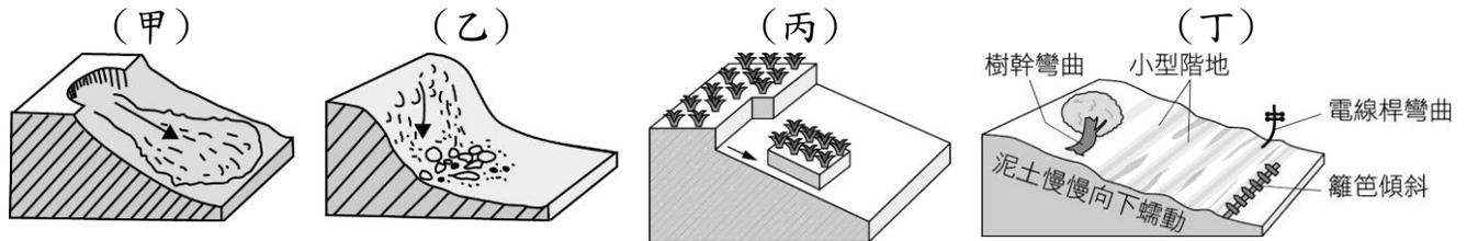
圖 5 4 種崩壞作用示意圖
